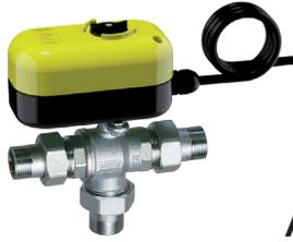
Vanne de zone déviatrice à bille 3 voies, chromée, avec raccords, écrous et servomoteur électrique 24 V.
