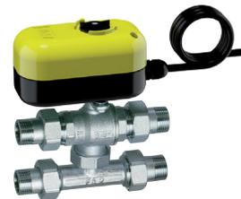
Vanne de zone à bille 3 voies, chromée, avec té de bypass, raccords, écrous et servomoteur électrique 24 V.
