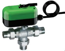
Vanne de zone déviatrice à bille 3 voies, chromée, avec raccords, écrous et servomoteur électrique 24 V avec déblocage manuel.
